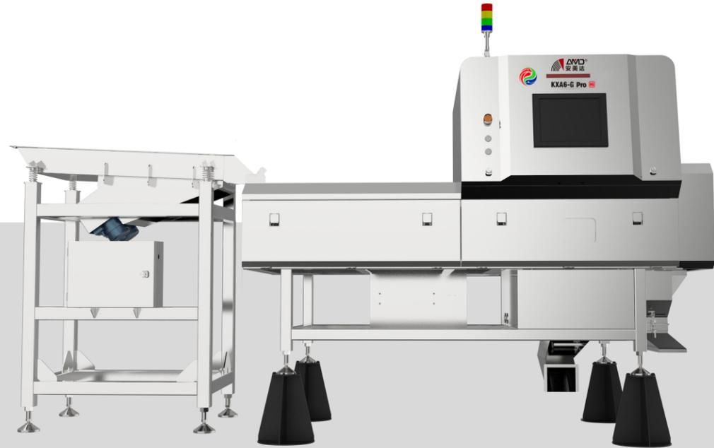
KX-G Pro系列坚果类异物品控卫士，针对坚果类内质问题专属设计，X光分选性能再度跃升，领先的深度学习技术赋能；超清多维识别品控，精准识别小萎缩、空瘪、虫蚀、变质、霉变、发芽等行业难题；把控精度全面提升，品质安全更有保障。行业领先大产量、高精度，产线适配性更强，中科一体化品控产线解决方案，强强联合，成就完美品质。
